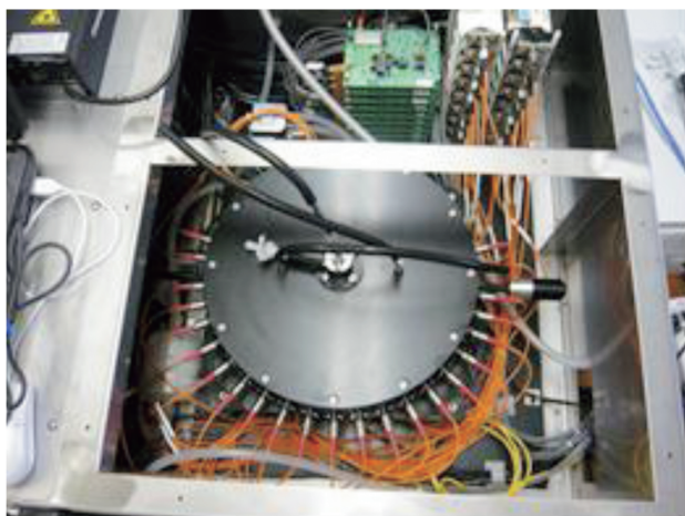
図3：開発中のポーラーネフェロメータの内部．円形セルの中心にサンプル空気の導入部があり、周辺には散乱光を散乱角度別に検出器へ引き込むための光ファイバーが設置されている．
