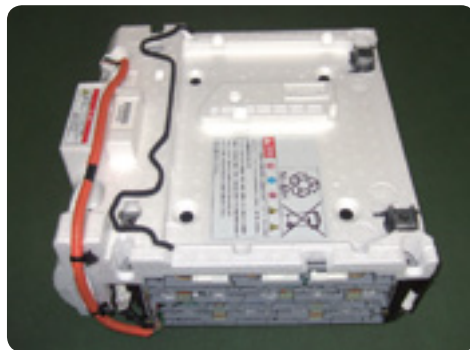
インサイトのトランク下部に搭載されるIMAバッテリー
